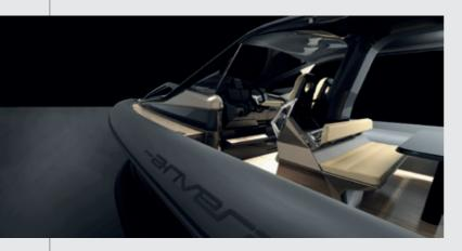
Lunghezza fuori tutto//LOA 14.50m Immersione//Draft 1.11m Baglio massimo//Maximum beam 4.91m 9/10.5 tons Dislocamento (lightship)//Light displacement Motore//Main propulsion 370/550 hp Propulsione//Propulsion Surface drive/Sterndrive Capacità carburante//Fuel tank volume 14001 4001 Capacità Acqua//Water tank volume Autonomia//Range 320/370 na mi Certificazione CE//EC Certification **B** Category www.anvera.it
