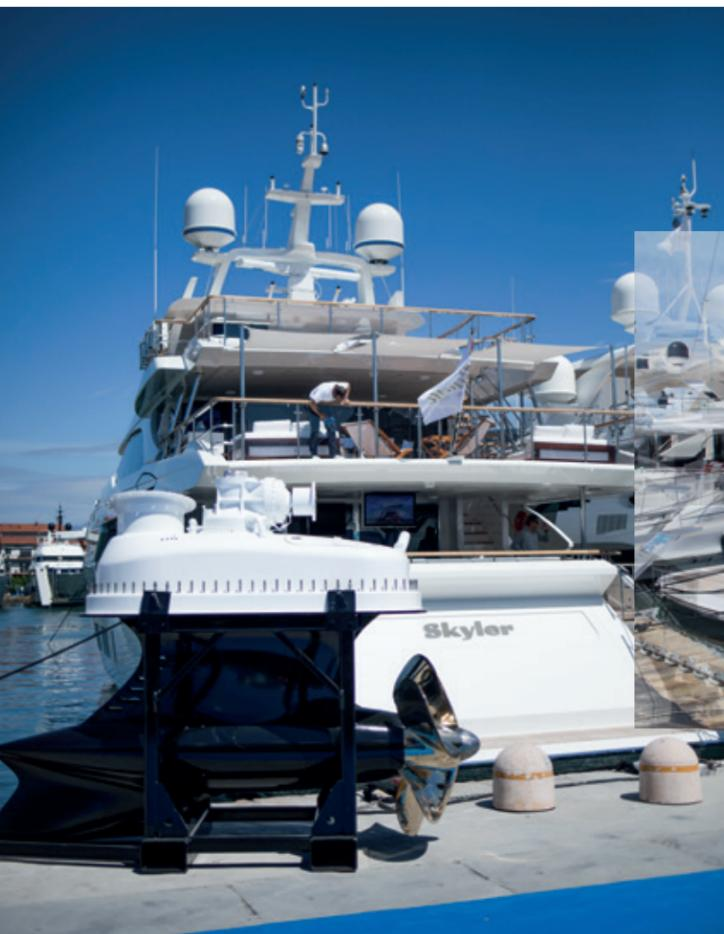
Il cantiere nautico Benetti ha presentato il 125 piedi *Skyler* equipaggiato con il sistema di propulsione Azipull Carbon 65 di Rolls Royce. Sotto, il Baglietto Navy FFC15.
